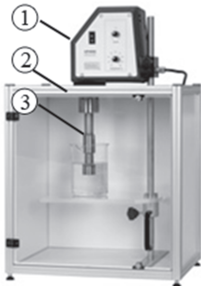
Рис. 1. Ультразвуковой процессор HielscherUP400S: 1 – ультразвуковой процессор; 2 – звукозащитный бокс; 3 – соноотрод
